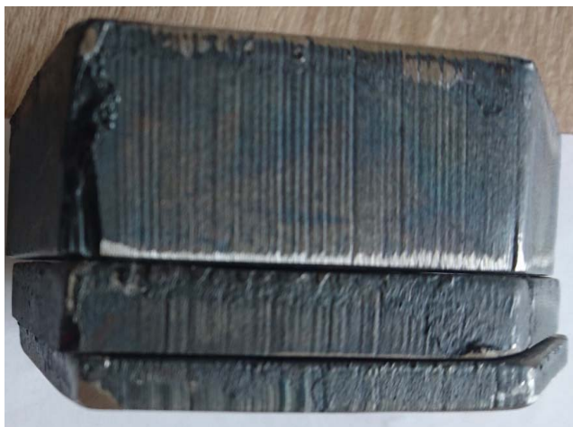
Slika 1. Izgled obradene površine pri rezanju čelika abrazivnom vodenim mlazom
