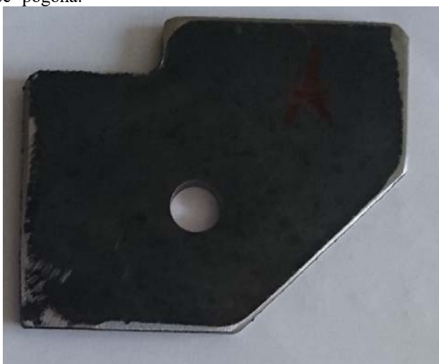
Slika 2. Izgled dijela dobijen rezanjem abrazivnim vodenim mlazom
